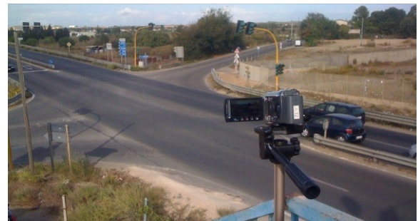
Foto 8 – Esempio di installazione per rilievo con telecamere
